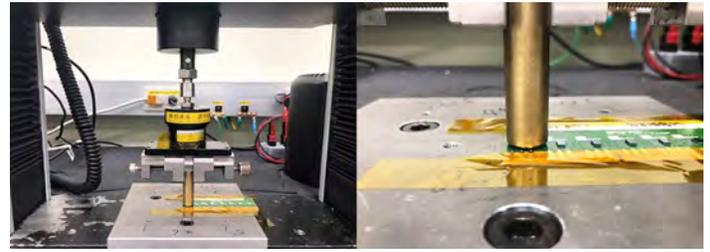
図27: 圧力テスト装置。テスター・ヘッドは、0.6 mm/分の一定の荷重速度にして、所定の力がゲージによって検出されるまで、デバイスの裏側に下がります。DUTは、テスト段階で、安全に固定されているFR4テスト・クーポンに表面実装されています。
