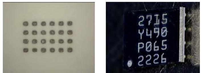
図31: (左図) セラミック基板に押し付けられたはんだステンシル・パターン。(右図) 基板へのリフロー後のEPC2715。
